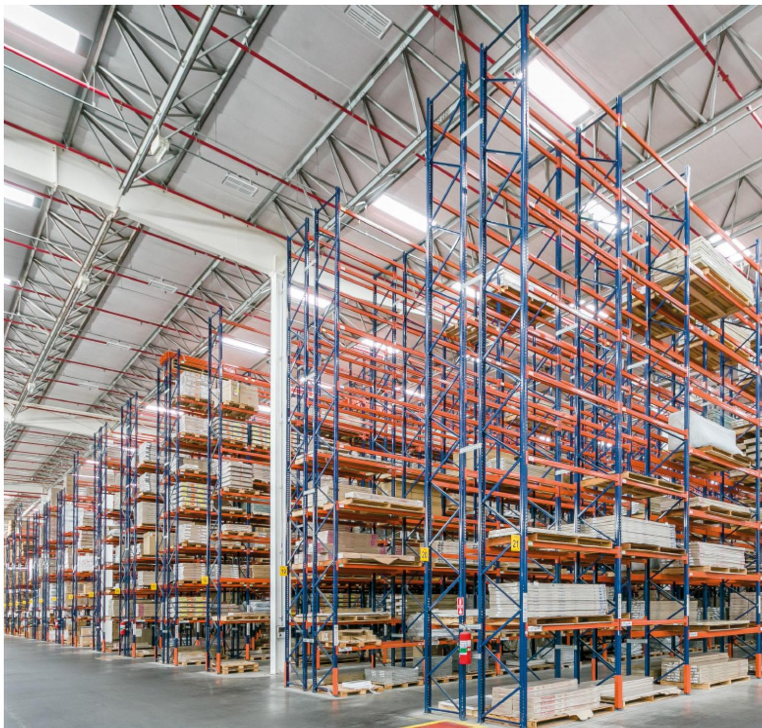
**Mecalux a installé des rayonnages à palettes dans l'entrepôt de Magazine Luiza, entreprise spécialisée dans la vente en ligne de produits électroniques, située dans la ville brésilienne de Guarulhos. Grâce à ce système, l'entreprise a atteint une capacité de stockage supérieure à 15 300 palettes.**
