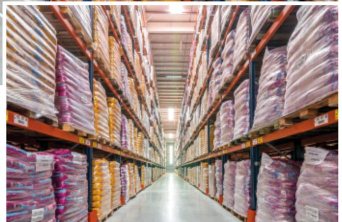
Mecalux a installé le système de rayonnages à palettes dans les deux nouveaux entrepôts que Qbox a construit dans son centre logistique d'Argentine. La capacité de stockage totale obtenue est supérieure à 29 500 palettes. Ces rayonnages peuvent stocker des produits de plusieurs dimensions et caractéristiques, tout en étant très appropriés pour réaliser le picking directement sur les palettes mêmes.
