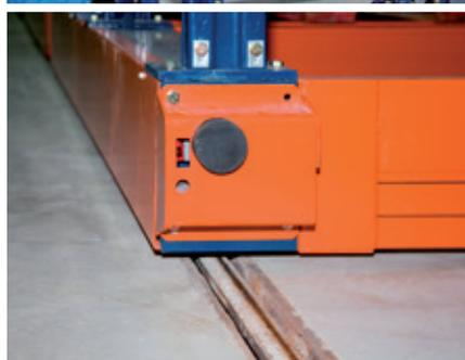
Mecalux a installé des rayonnages à palettes sur bases mobiles Movirack au sein de la chambre froide de Cárnica Batallé. Cette entreprise, située à Riudarenes (Gérone), est spécialisée dans la découpe de viande de porc. Sa chambre froide s'étend sur une surface de 1 485 m<sup>2</sup>. Ce système exploite au maximum l'espace disponible et offre une capacité de stockage de plus de 3 900 palettes.
