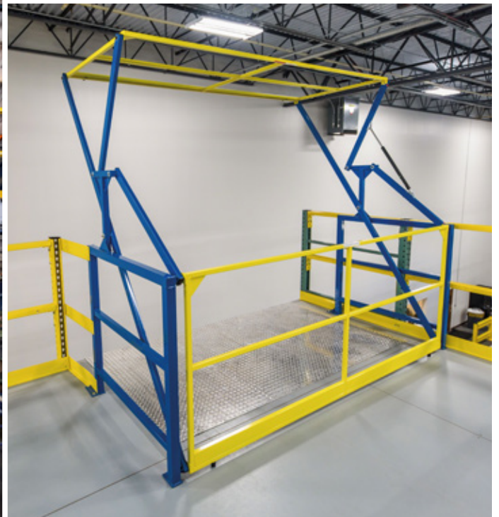
Des portes battantes de sécurité ont également été installées afin de créer une zone de chargement et de déchargement de la marchandise manipulée au moyen de chariots élévateurs.
