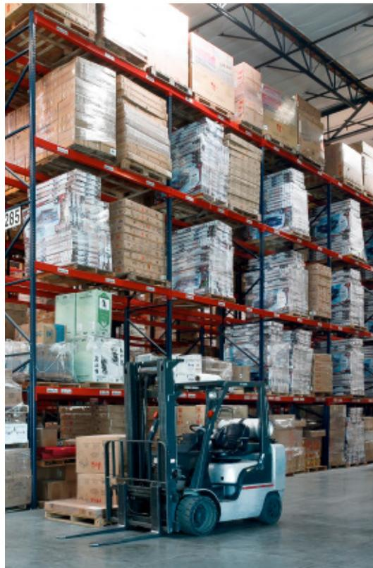
La Californie étant principalement connue pour son activité sismique élevée, les rayonnages à palettes vissés d'Interlake Mecalux sont spécialement conçus et renforcés dans le but d'absorber la force produite par d'éventuels mouvements sismiques
