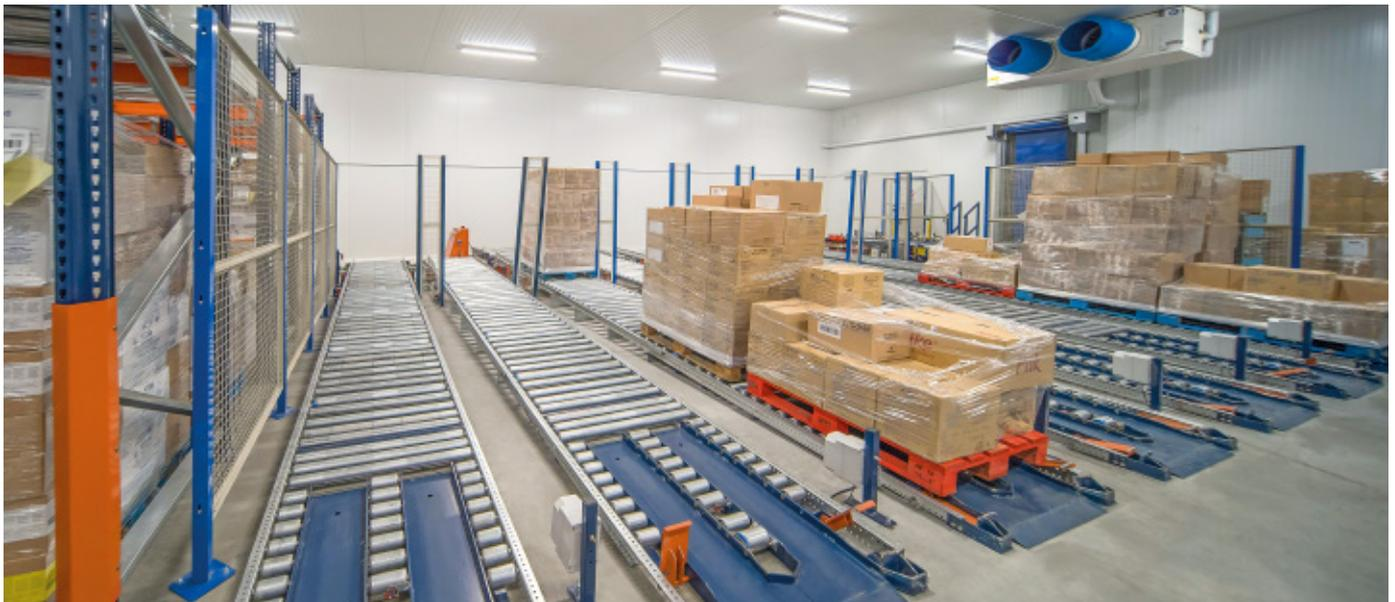
**La sécurité de la marchandise. La zone d'expédition fonctionne également à température contrôlée pour ne pas interrompre la chaîne du froid. De plus, les butées, les rouleaux de frein et autres dispositifs installés dans les canaux de préchargement contrôlent de manière automatique la vitesse et l'arrêt des palettes sans embouteillages ni collisions.**
