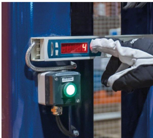
Le dispositif lumineux (*put-to-light*) montre le nombre de références à déposer sur chaque palette. Une fois le processus achevé, l'opérateur appuie sur le bouton pour informer le WMS. Ce système accélère fortement les opérations, réduit les erreurs dans la préparation de commandes et permet de mettre à jour le stock en temps réel grâce à la transmission d'information au WMS.
